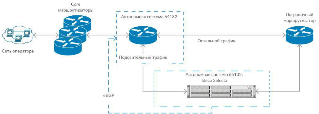
Ideco Selecta по eBGP экспортирует на маршрутизатор провайдера список подозрительных маршрутов (список Роскомнадзора + настраиваемый чёрный список), пропуская этот трафик через себя.
