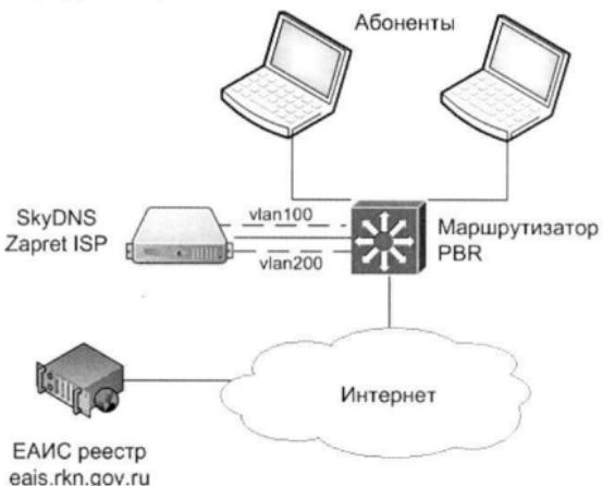
При такой схеме можно настроить два VLAN. На vlan100 настроить OSPF или BGP, а через vlan200 настроить выход в интернет. На маршрутизаторе настроить PBR (Policy Based Routing), чтобы запросы из vlan200 не маршруттизировались во vlan100, а уходили в интернет.
